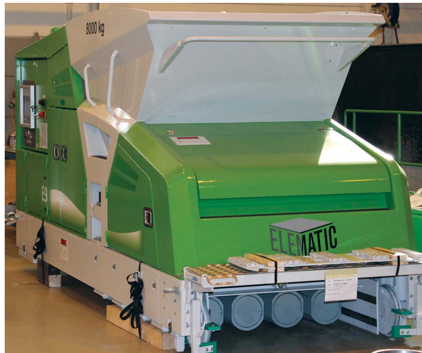
Obr. 4: Stroj na výrobu předpjatých stropních panelů SPIROLL
